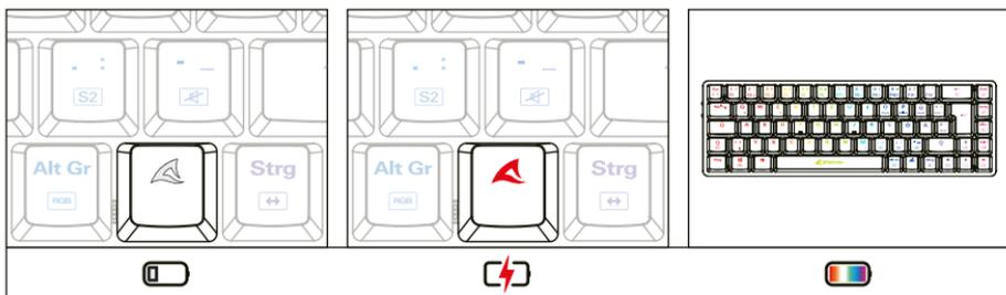
Die Fn-Taste blinkt wiederholt weiß auf, wenn der Akkustand der Tastatur niedrig ist. Die Fn-Taste leuchtet rot, wenn die Tastatur aufgeladen wird. Ist die Tastatur vollständig aufgeladen, kehrt die Beleuchtung der Fn-Taste wieder zur aktuell festgelegten Hintergrundbeleuchtung zurück.
