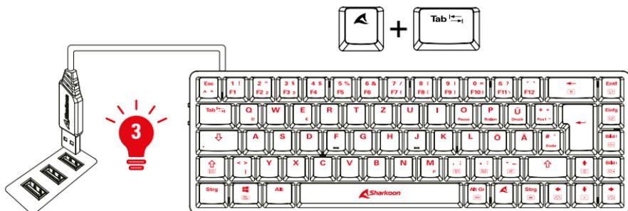
Drücken Sie Fn + Tab um zum kabelgebundenen Modus zu wechseln. Die Hintergrundbeleuchtung blinkt dreimal rot auf, um anzuzeigen, dass der kabelgebundene Modus aktiv ist.
